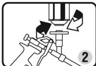
2. Den Abzug betätigen, damit der Schaum hinausströmen kann (ca. 2 Sekunden). Auf diese Weise wird das Verlängerungsrohr mit Schaum gefüllt. Die Pistole ist nun gebrauchsfertig. Während des Auftrags des Schaums die Pistole mit dem Behälter in einer aufrechten Position halten. Der Schaumaustritt kann über den Abzug eingestellt und mit Hilfe der Einstellschraube auf der Rückseite der Pistole kontrolliert werden
