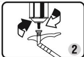
2. Quitar el tapón y enroscar la cánula. Sujetar el bote boca abajo y proyectar la espuma presionando la válvula.
