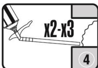
4. Se debe tener en cuenta que la espuma puede expandir entre 2 y 3 veces. Si se está rellenando una cavidad de más de 5 cm, trabajar por capas. Aplicar la segunda capa una vez se ha endurecido la primera. Una vez la espuma se ha endurecido, cortar con un elemento afilado y enlucir, cubrir, pintar, etc.
