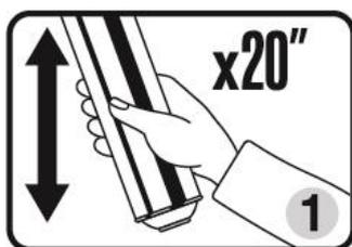
1. Las superficies han de estar limpias de polvo, grasa, aceite y otras impurezas. Las superficies secas y porosas han de ser humedecidas con agua. La temperatura óptima de trabajo del bote es entre 20°C y 25°C. Si la temperatura es más baja, colocar el bote en agua caliente (max. T=40°C) unos 20 minutos. Agitar el bote exhaustivamente (20 veces aproximadamente) con la válvula hacia abajo antes de usar.
