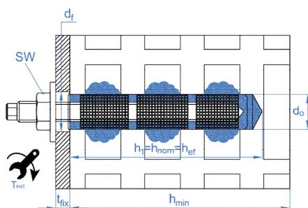
La fixation dans la brique creuse implique nécessairement l'utilisation d'un tamis plastique ou métallique pour éviter que la résine ne passe par les trous intérieurs.
