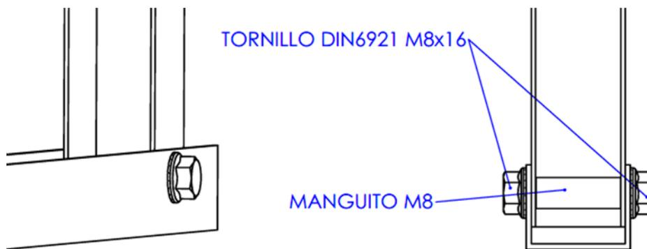
4. Pour le fixer correctement, appliquer un couple de serrage de 15 Nm.
