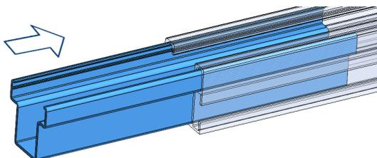
**B.** Fixer la connexion PSE-CUN au premier profil PSE-C en installant 2 vis auto-perceuses en acier inoxydable ABEI5519. Les vis doivent être installées dans la partie inférieure du profil, à une distance de 50 à 70 mm de l'extrémité du profilé. Pour l'installation des vis ABEI5519, un tournevis électrique équipé d'une douille hexagonale SW-8 est nécessaire. La vitesse d'installation de 1 800 tr/min est recommandée.
