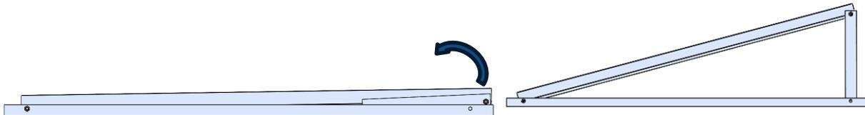
2. Monter le profilé inférieur arrière avec les éléments contenus dans le sac.
