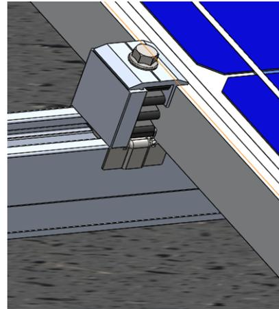
La taille des gabarits choisis doit être égale à la hauteur du cadre des panneaux solaires à installer.
