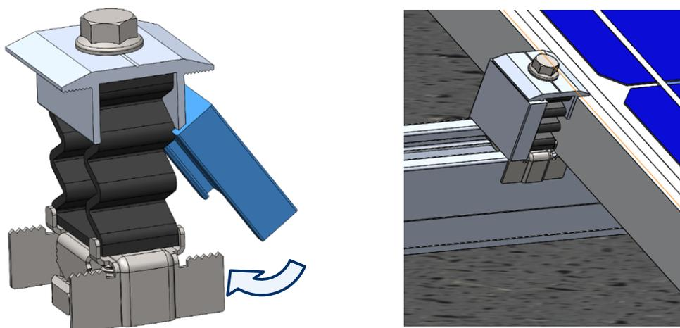
La misura dei calibratori scelti deve essere pari all'altezza del telaio dei pannelli solari da installare.
