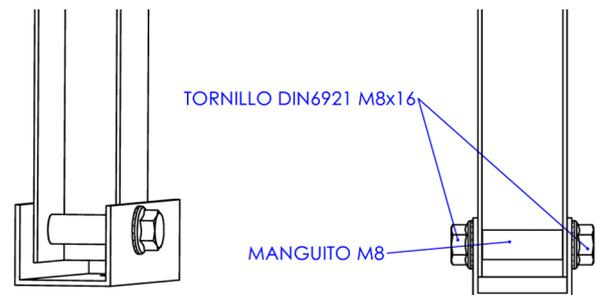
4. Per fissarlo correttamente in posizione, è necessario applicare una coppia di serraggio di 15 Nm.
