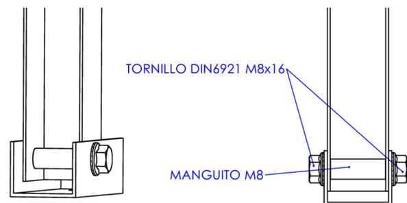
4. Für eine korrekte Befestigung ist ein Anzugsmoment von 15 Nm erforderlich.
