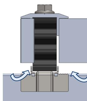
3. Introduzir os elementos correspondentes, duas placas caso se trate de um grampo intermédio ou placa e espaçador caso se trate de um grampo final.
