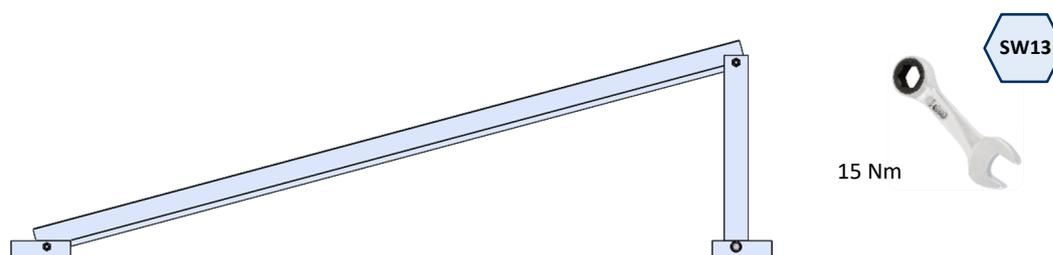
**PASSO 4 - Instalação dos triângulos**
