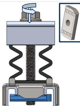
2. Para fixar o grampo ao perfil é necessário girar a cabeça inferior até à posição perpendicular ao perfil com recurso ao parafuso, pressionando a cabeça do parafuso e girando-a. A porca conta com um perfil dentado para garantir a fixação.
