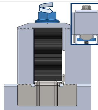
4. Para fixar os elementos introduzidos é necessário girar o parafuso até que entre em contacto com o perfil. Verificar se a cabeça inferior continua perpendicular ao perfil.
