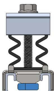
1. Colocar o grampo nos perfis com a cabeça inferior paralela ao guia.
