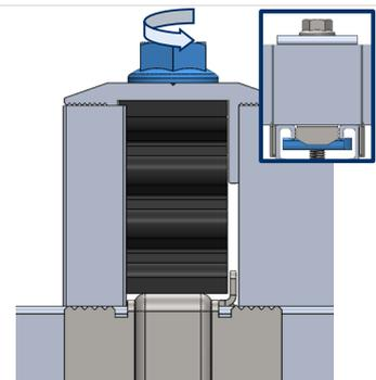
4. Um die eingesetzten Elemente zu befestigen, muss die Schraube gedreht werden, bis sie das Profil berührt. Es ist darauf zu achten, dass der untere Kopf senkrecht zum Profil steht.
