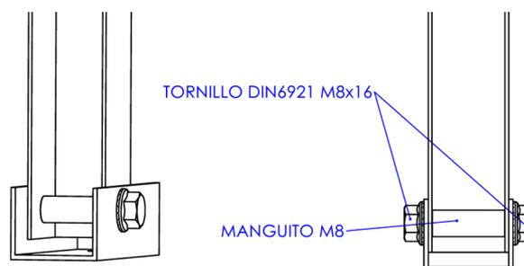
4. Für eine korrekte Befestigung ist ein Anzugsmoment von 15 Nm erforderlich.
