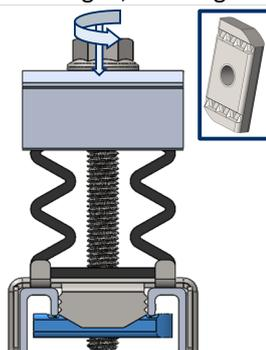
2. Um die Klemme am Profil zu befestigen, muss der untere Kopf mit Hilfe der Schraube senkrecht zum Profil gedreht, der Schraubenkopf eingedrückt und gedreht werden. Die Mutter hat ein Zahnprofil, um die Befestigung zu sichern.
