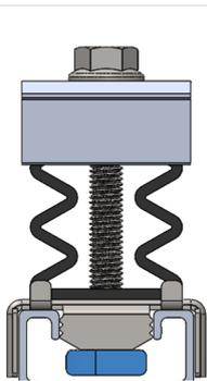
1. Die Klemme so in die Profile einsetzen, dass der untere Kopf parallel zur Führung liegt.
