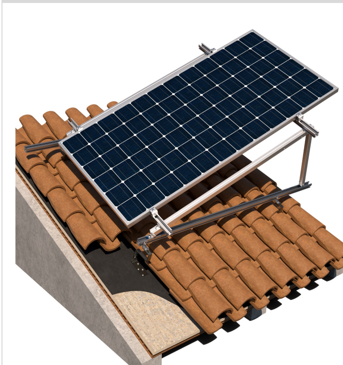
Beispiel 2: Dach mit gebogenem Dachziegel mit Unterkonstruktion aus Holz / Befestigung mit Doppelgewindeschraube KFS-MA
