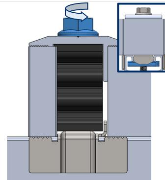
**4.** Per fissare gli elementi inseriti, è necessario ruotare la vite finché non entrano in contatto con il profilo. Verificare che la testa inferiore rimanga perpendicolare al profilo.
