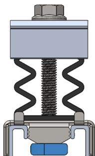
**1.** Posizionare il morsetto sul profilo con la testa inferiore parallela al profilo.
