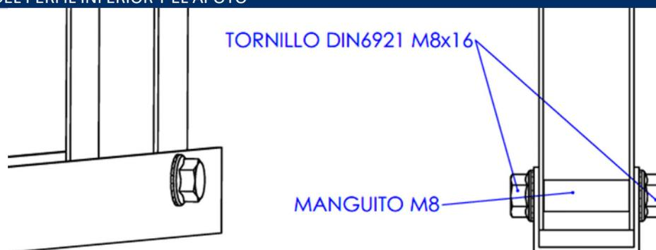
4. Para fijar correctamente su posición, hay que aplicar un par de apriete de 15 Nm.
