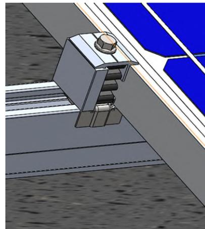
La medida de galgas elegidas debe ser igual a la altura de marco de las placas solares a instalar.
