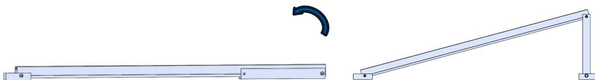
3. Colocar el perfil inferior trasero con los componentes encontrados en la bolsa.
