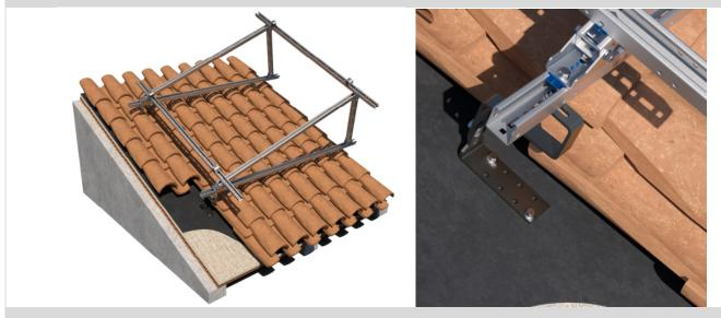
Exemplo 2: Cobertura de telha curva com subestrutura de madeira / fixação com parafuso de rosca dupla KFS-MA
