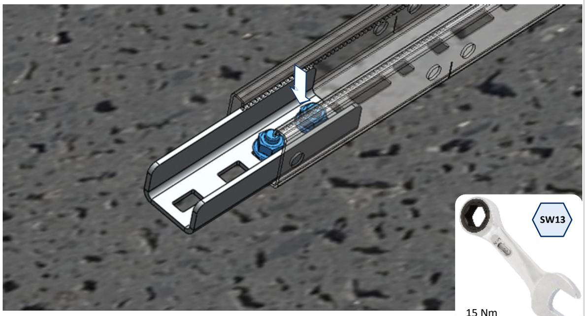
C. Introduzir a extremidade livre da união EMP-XS no segundo guia GP-XS.
