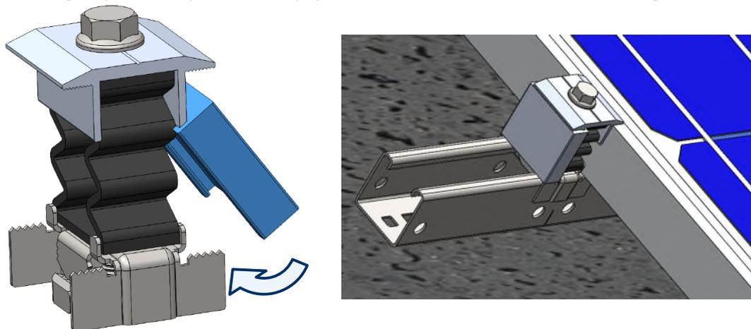
A medida dos espaçadores escolhidos deve ser igual à altura da estrutura dos painéis solares a instalar.
