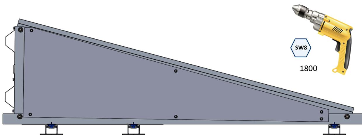
Los cortavientos traseros se fijan con tres tornillos autotaladrantes como se muestra en la imagen.
