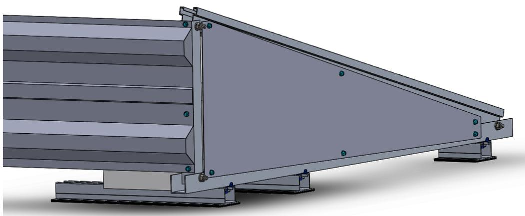
**PASO 5.- Conexión longitudinal entre perfiles**
