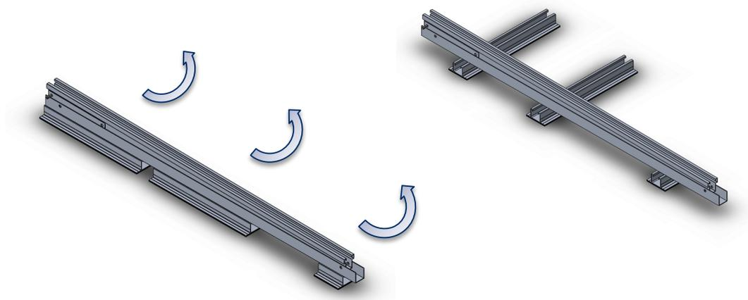
Posicionar el perfil de apoyo a 90° respecto al perfil inferior, introducir el tornillo inoxidable a través de ambos perfiles colocando un casquillo para que al aplicar el par de apriete no se deformen los perfiles y por último colocar la tuerca inoxidable en el otro extremo y aplicar par de apriete de 15N/m.
