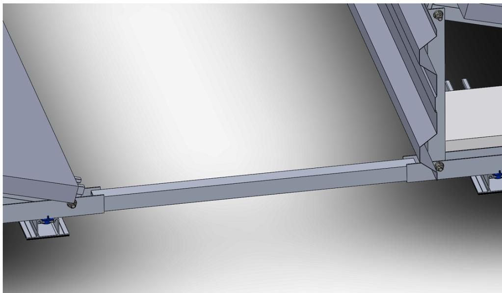
Fijar el perfil de unión a los perfiles inferiores mediante la instalación de 2 tornillos auto taladrantes inoxidables en cada lado. Los tornillos se deben instalar en los laterales del perfil, en forma de cruz para que no choquen entre ellos. Para la instalación de los tornillos se necesita atornillador eléctrico equipado con vaso hexagonal SW-8, se recomienda una velocidad de instalación de 1800 rpm.
