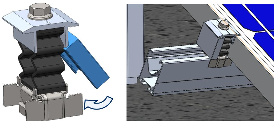
La taille des gabarits choisis doit être égale à la hauteur du cadre des panneaux solaires à installer.
