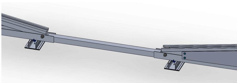
Fixez le profilé de raccordement aux profilés inférieurs à l'aide de deux vis auto-taraudeuses en acier inoxydable de chaque côté. Les vis doivent être installées en croix sur les côtés du profilé, afin qu'elles ne se heurtent pas. Pour l'installation des vis, un tournevis électrique équipé d'une douille hexagonale SW-8 est nécessaire. La vitesse d'installation de 1 800 tours/minute est recommandée.
