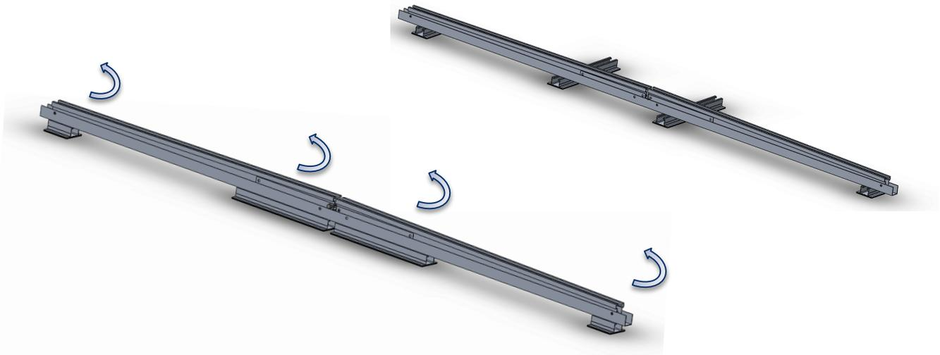
Placez le profilé de support à 90° par rapport au profilé inférieur, insérez la vis inoxydable à travers les deux profilés en plaçant une bague anti-déformation lors du serrage, puis positionnez l'écrou inoxydable à l'autre extrémité et appliquez un couple de serrage de 15 N·m.
