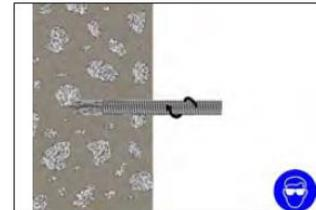
8. L'excès de résine sortira du trou de façon uniforme autour du composant métallique ce qui indiquera que le trou est comblé.
