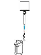
9. Insérer la canule mélangeuse au fond du trou. Injectez la résine et retirez lentement la buse du trou, en évitant de former des chambres d'air dans le trou. Remplissez environ 3/4 du trou. Avant de retirer complètement la buse.
