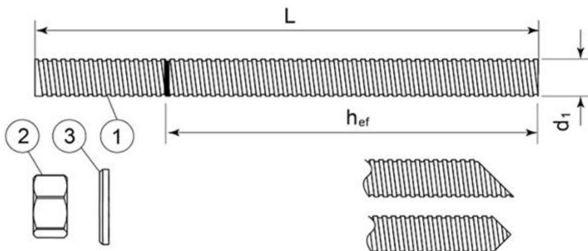
Tige standard commerciale filetée avec profondeur d'ancrage signalée
