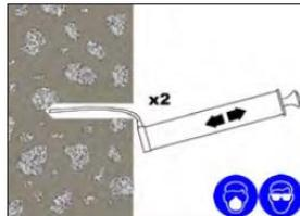
**Si se acumula agua en el orificio después de la limpieza inicial, deberá eliminarse dicha agua antes de inyectar la resina.**
