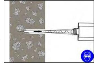
6. Insertar la cánula (retenedor de resina / tubo alargador si es necesario) hasta el fondo del orificio. Comenzar a inyectar la resina y retirar lentamente la cánula del orificio asegurándose de que no queden burbujas de aire mientras se retira la cánula. Rellenar aproximadamente  $\frac{1}{2}$  o  $\frac{3}{4}$  del orificio y retirar la cánula por completo.
