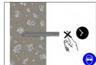
10. Anbauteil montieren und Mutter mit dem empfohlenen Drehmoment festziehen.
