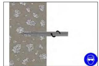
8. Si cualquier exceso de resina saliese del orificio de manera uniforme alrededor del elemento de acero, sería síntoma de que el orificio está lleno.
