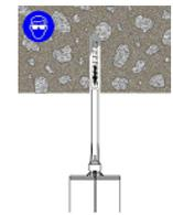
11. Introduire l'élément d'ancrage en acier exempt d'huiles ou d'autres résidus et marquez la profondeur d'encastrement nécessaire. Insérez dans le trou l'élément en acier en appliquant un mouvement rotatif vers l'avant puis vers l'arrière afin de bien l'enrober jusqu'à ce qu'il arrive au fond du trou.
