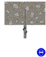
L'excès de résine sortira du trou de façon uniforme autour de l'élément en acier et il ne restera plus d'espace entre l'élément d'ancrage et la paroi du trou foré.
