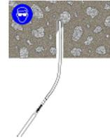
10. Insérer la canule mélangeuse au fond du trou. Extrudez la résine et retirez lentement la canule du trou. Veillez à ce qu'il ne se produise aucune bulle d'air pendant que vous retirez la canule. Injectez la résine jusqu'à remplir environ  $\frac{3}{4}$  du trou puis, retirez la canule
