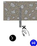
14. Incorporez l'élément à fixer et serrez l'écrou au couple de serrage requis.
