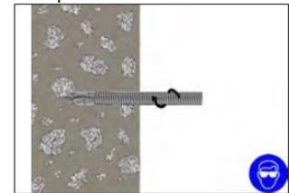
8. La resina sobrante saldrá del orificio uniformemente alrededor del componente metálico indicando que el orificio está lleno. Dicha resina sobrante debe retirarse de la boca del orificio antes de que se seque.
