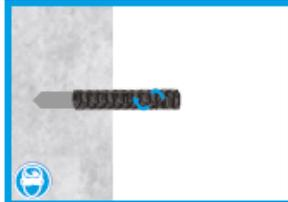
Den Bewehrungsstab frei von Öl oder sonstigen Substanzen mit einer vorwärts und rückwärts ausgeführten Drehbewegung bis zum Bohrlochgrund einführen. Dabei sicherstellen, dass alle Gewindegänge vollständig bedeckt sind. Innerhalb der vorgegebenen Verarbeitungszeit die Position justieren.
