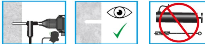
1. Verwenden Sie den angegebenen Hohlbohrer und befolgen Sie die Anweisungen des Herstellers. Vergewissern Sie sich, dass das Vakuumsystem eingeschaltet ist.
